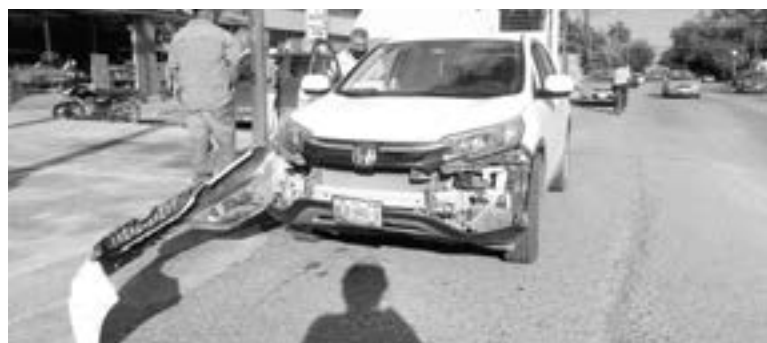
A LA HONDA CR-V se le desprendió la fascia delantera.
