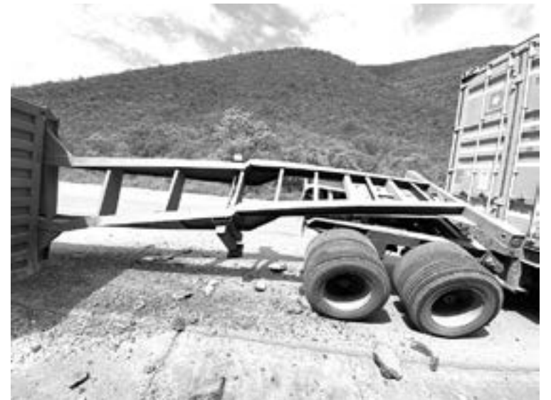
LA UNIÓN entre ambos contenedores se torció.
